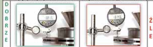
Staraj się mierzyć bicie blisko zewnętrznej krawędzi tarczy (ok. 10mm od krawędzi)
