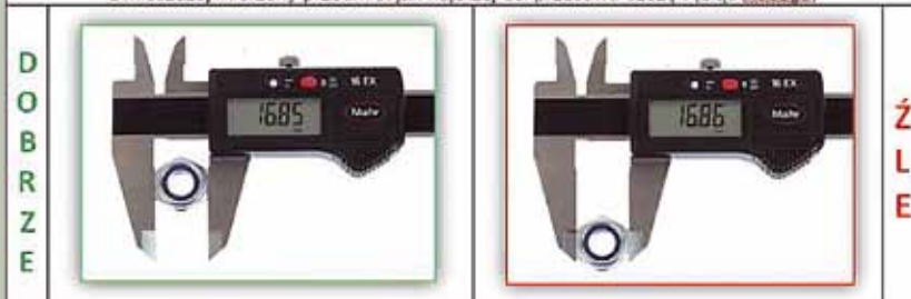
Nacisk pomiarowy - nie dociska zbyt mocno szczęki przesuwnej
