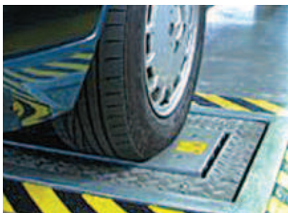
Fot.2 Zdjęcia amortyzatora na stanowisku typu Boge. Badanie amortyzatora bez jego demontażu.
